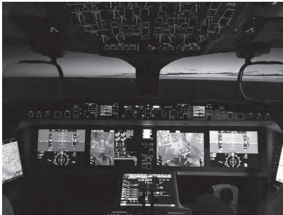
Grosses Primary Flight Display und reale Kartendarstellung mit Relief auf der Map Page (Bild: D. Nater).
