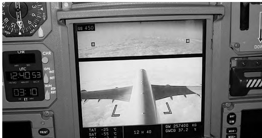
Im Flug können die TACS-Bilder ausschliesslich auf das System Display übertragen werden.
