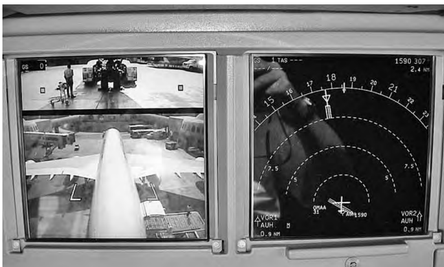
Projektion der Aussenaufnahmen auf das Primary Flight Display. Die speziellen Markierungen visualisieren den Radstand des Hauptfahrwerks und sind hilfreich bei engen Kurvenradien.
