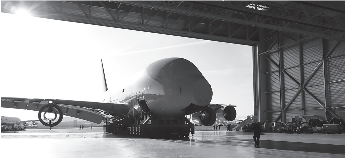
Ein Airbus 380 wird von TARMAC Aerosave ausgeschlachtet.
