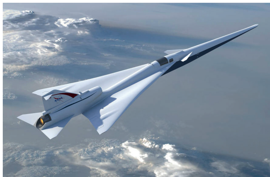
Die spitze Nase der X59 soll den Überschallknall deutlich reduzieren.
